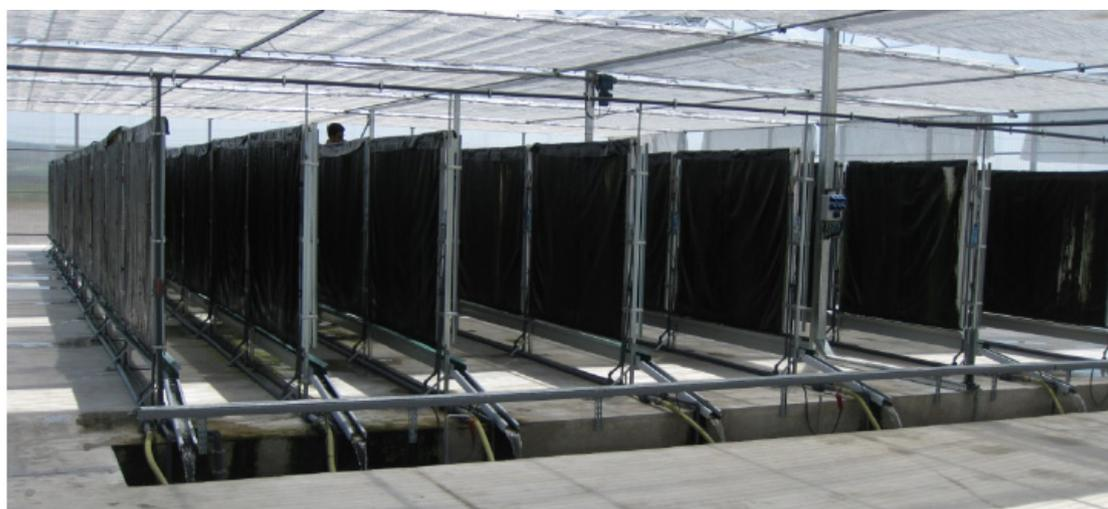
**Figura 5.** Vista de la planta experimental de producción de microalgas mediante el sistema PBRL en Valdecañas (Palencia). Se observan diversas filas de 10 paneles cada una con diversas separaciones entre ellas al objeto de estudiar la influencia de este parámetro sobre la producción de microalgas.
